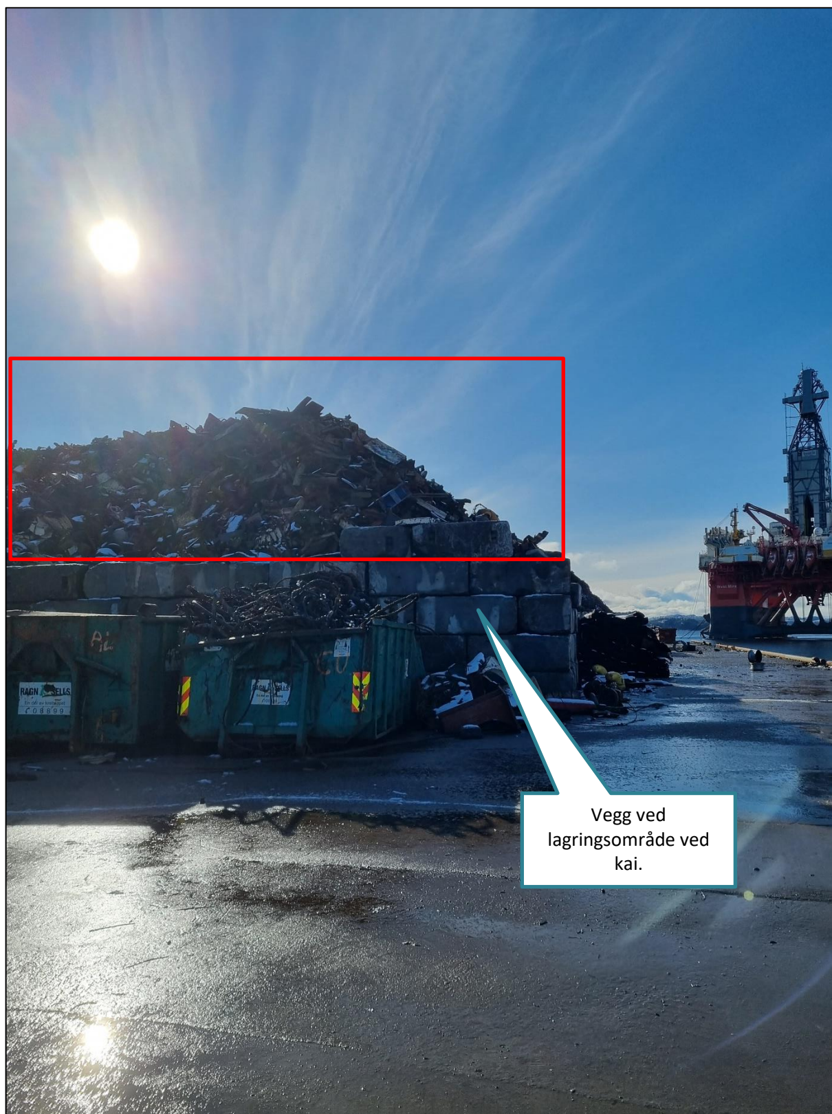
Figur 3-5: Område for lagring av metall ved kai. Støytiltak i form av økning av høyden på eksisterende vegg er vist med omrisset i rødt.
