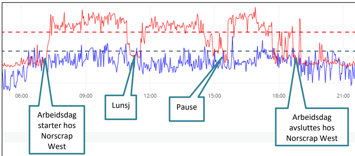
Figur 3-1: Figuren viser støynivået ved måleposisjon 1 (rød) og ved måleposisjon 2 (blå) ved en normal arbeidsdag hos Norscrap West. Grafen er hentet fra målingene 27.08.21 når det var svak vind, og det var lite støy fra vind. Den røde grafen viser en markant økning i støynivået på industriområdet når det er aktivitet hos Norscrap West. Den blå grafen, som viser støynivået hos nærmeste bolig, viser ingen markant økning i støynivået når det er aktivitet hos Norscrap West. Den blå grafen viser heller ingen markant reduksjon i støynivået når det ikke er aktivitet hos Norscrap West (lunsj, pause og avslutning av arbeidsdag). Dette indikerer at en normal arbeidsdag hos Norscrap West ikke gir markant økning i støynivået ved boligene.
